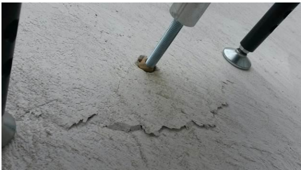
Abb. 3: Durchführung von Auszugsversuchen mit eingeklebten Gewindestangen im Bestand. Aufgrund der geringen Festigkeit des Bestandsmauerwerks werden die Gewindestangen nicht eingeklebt sondern durchgesteckt und mit Gegenplatte befestigt
